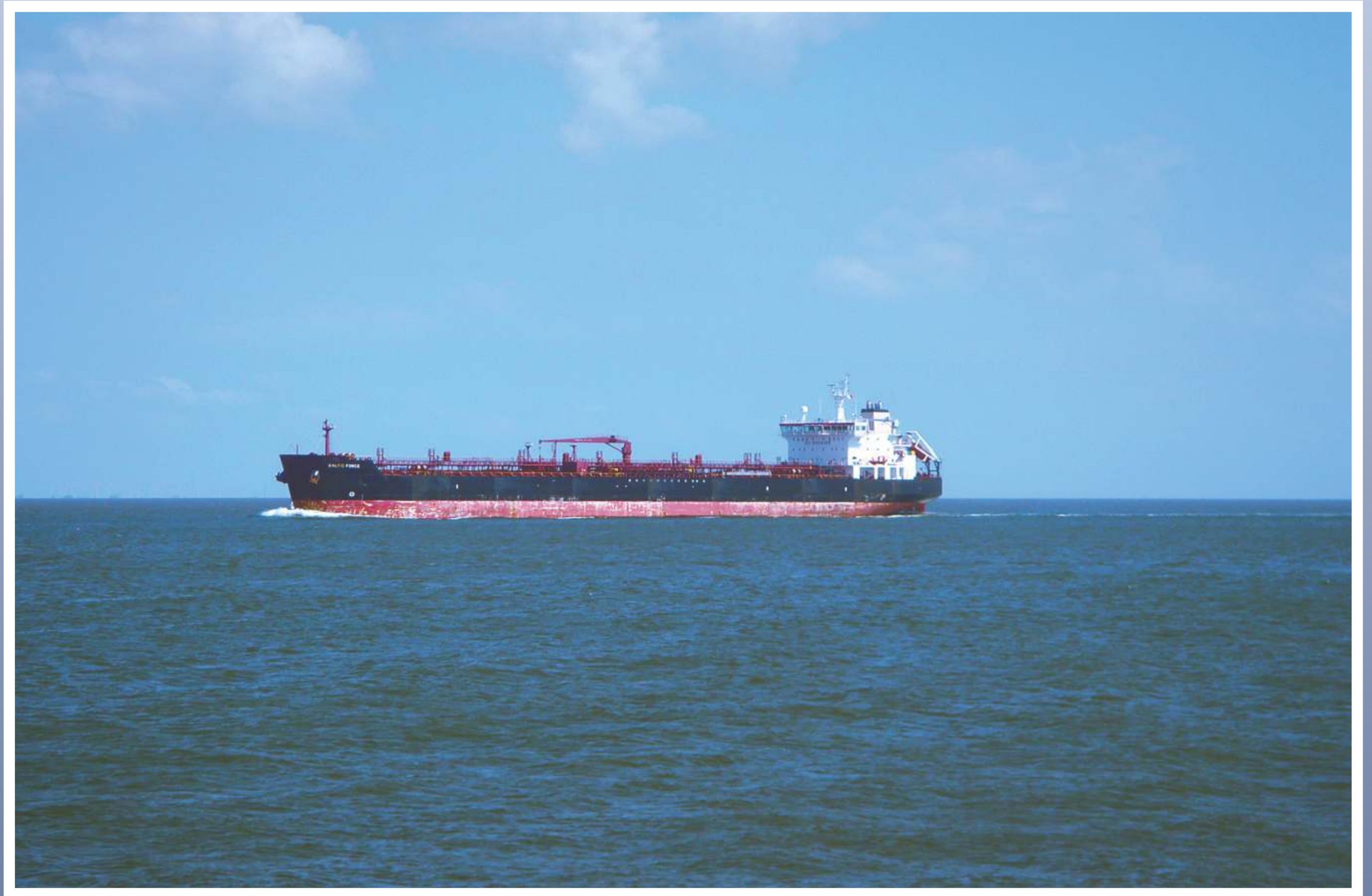
183 Meter lang, 27,37 Meter breit, Tiefgang voll beladen 10,85 Meter - die ‚Baltic Force‘. Der Öltanker, im Jahre 2006 gebaut, fährt unter zypriotischer Flagge und läuft maximal 13,7 kn gleich 25 km/h. Das Schiff passierte am 1. August 2015 auf der Fahrt nach Dunkerque (F) die ‚Alte Liebe‘.
