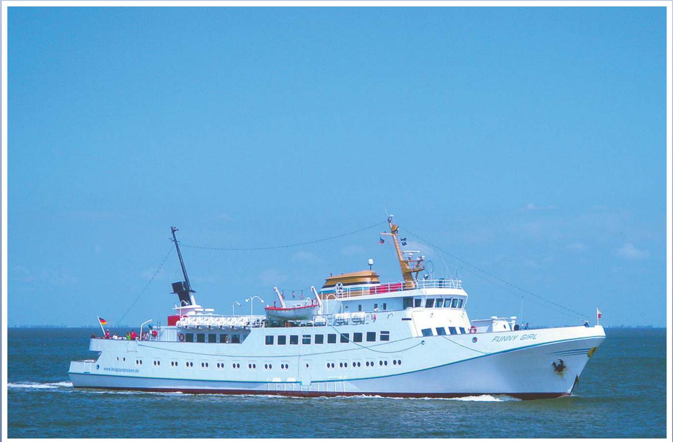
Die ‚Funny Girl‘ trifft auf der Rückfahrt von Helgoland wieder in Cuxhaven ein und passiert die ‚Alte Liebe‘. Das Seebäderschiff, 1972 auf der Mützelfeldtwerft in Cuxhaven erbaut, befördert auf seinen Reisen maximal achthundert Passagiere und läuft bis zu 19 Knoten (35 km/h).
