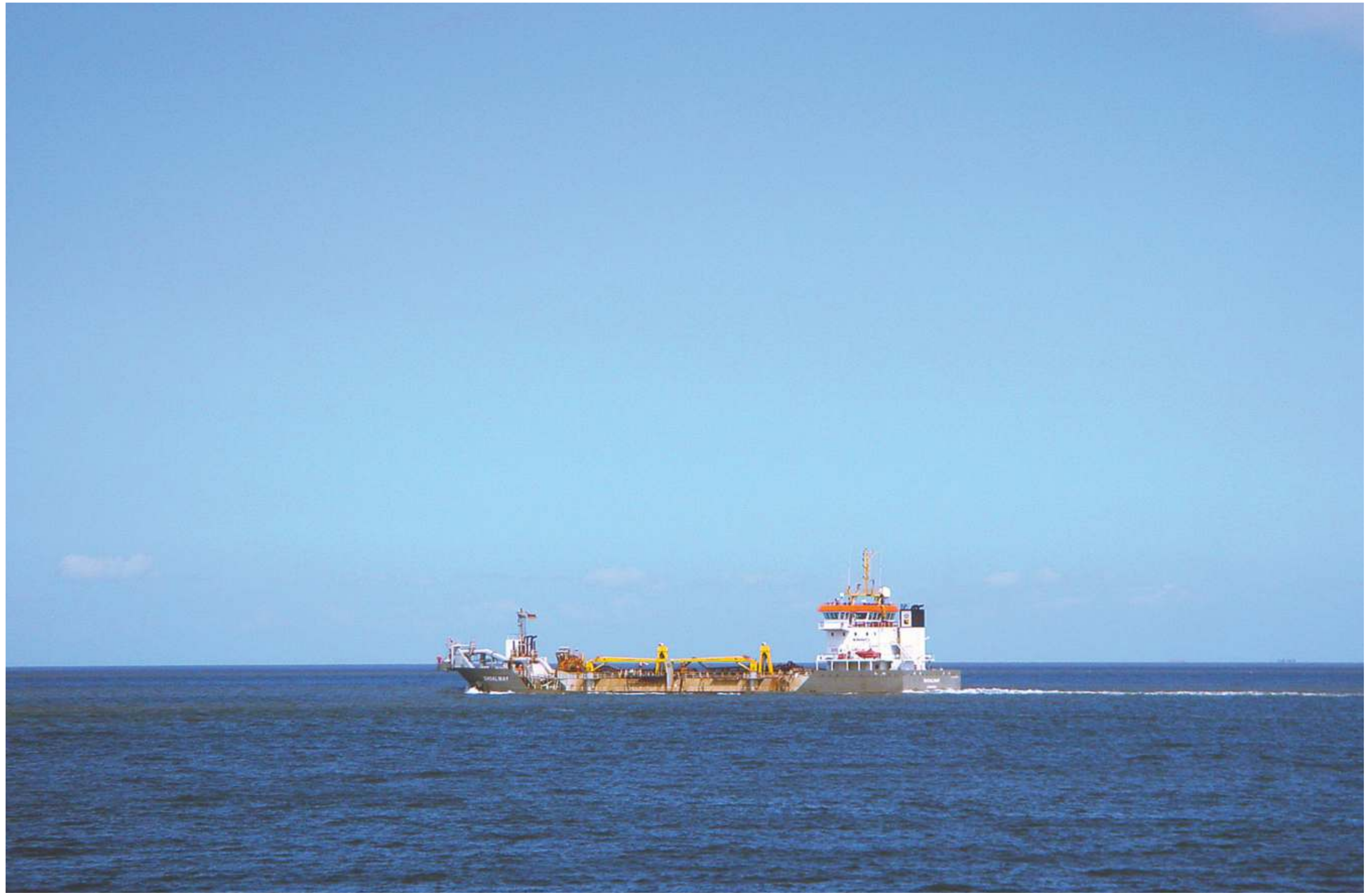
Ein Saugbagger verlässt voll beladen mit Schlamm die Elbe Richtung Nordsee, dort wird die Ladung verklappt. Das Spezia Schiff zählt zur Flotte von ca. 300 Baggerschiffen der Royal Boskalis Westminster N.V. (NL) und wird zur Freihaltung von Häfen und Wasserstraßen für den Schiffsverkehr eingesetzt.
