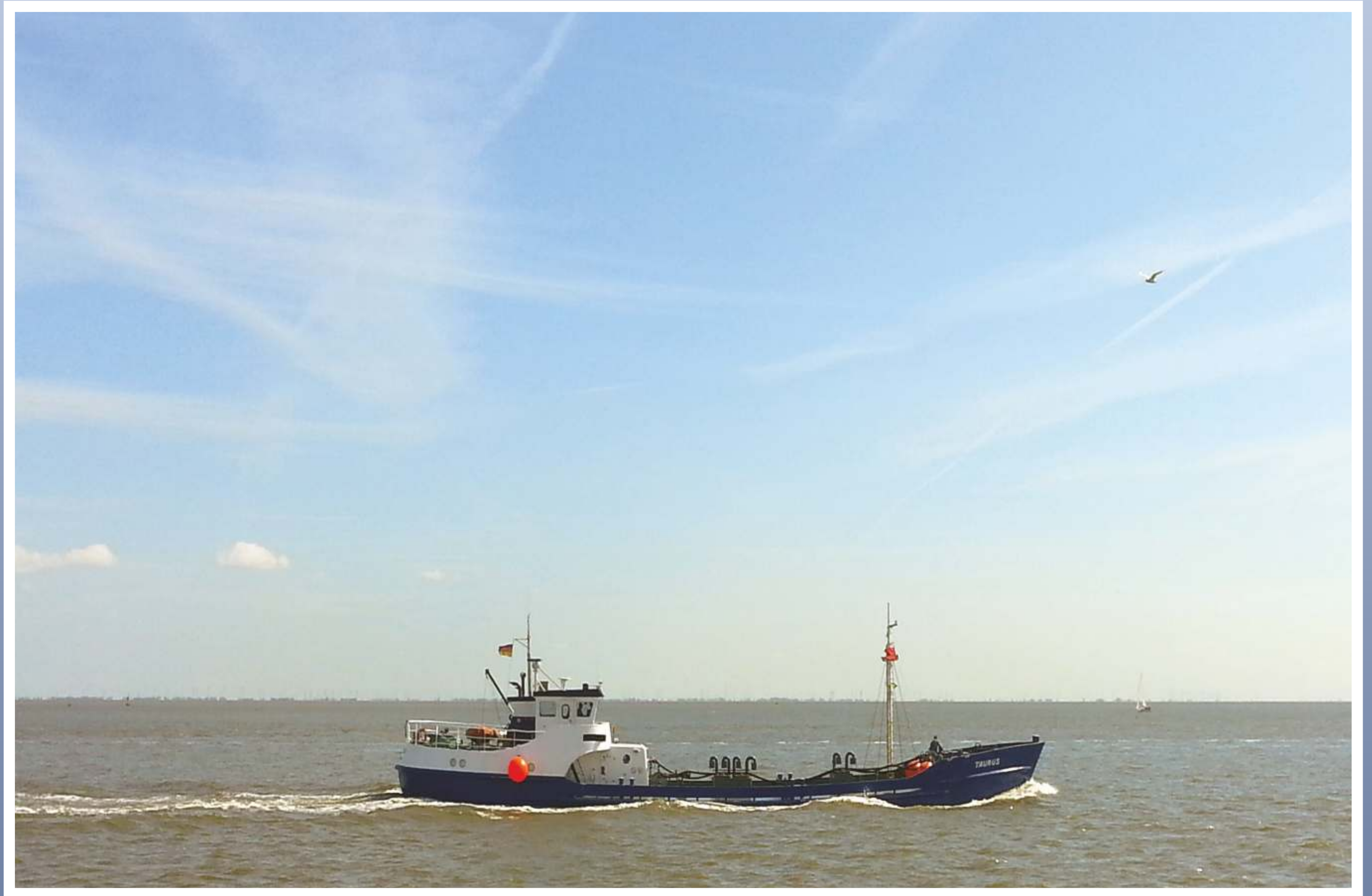
Das Bunkerboot ‚Taurus‘ vor der ‚Alten Liebe‘ in Cuxhaven, dem Heimathafen des Schiffes, das 1966 gebaut wurde. Spezialschiffe wie die ‚Taurus‘, auch Bunkerbargen oder Tankboote genannt, versorgen - bebunkern - andere Schiffe mit Brennstoffen und Schmieröl.
