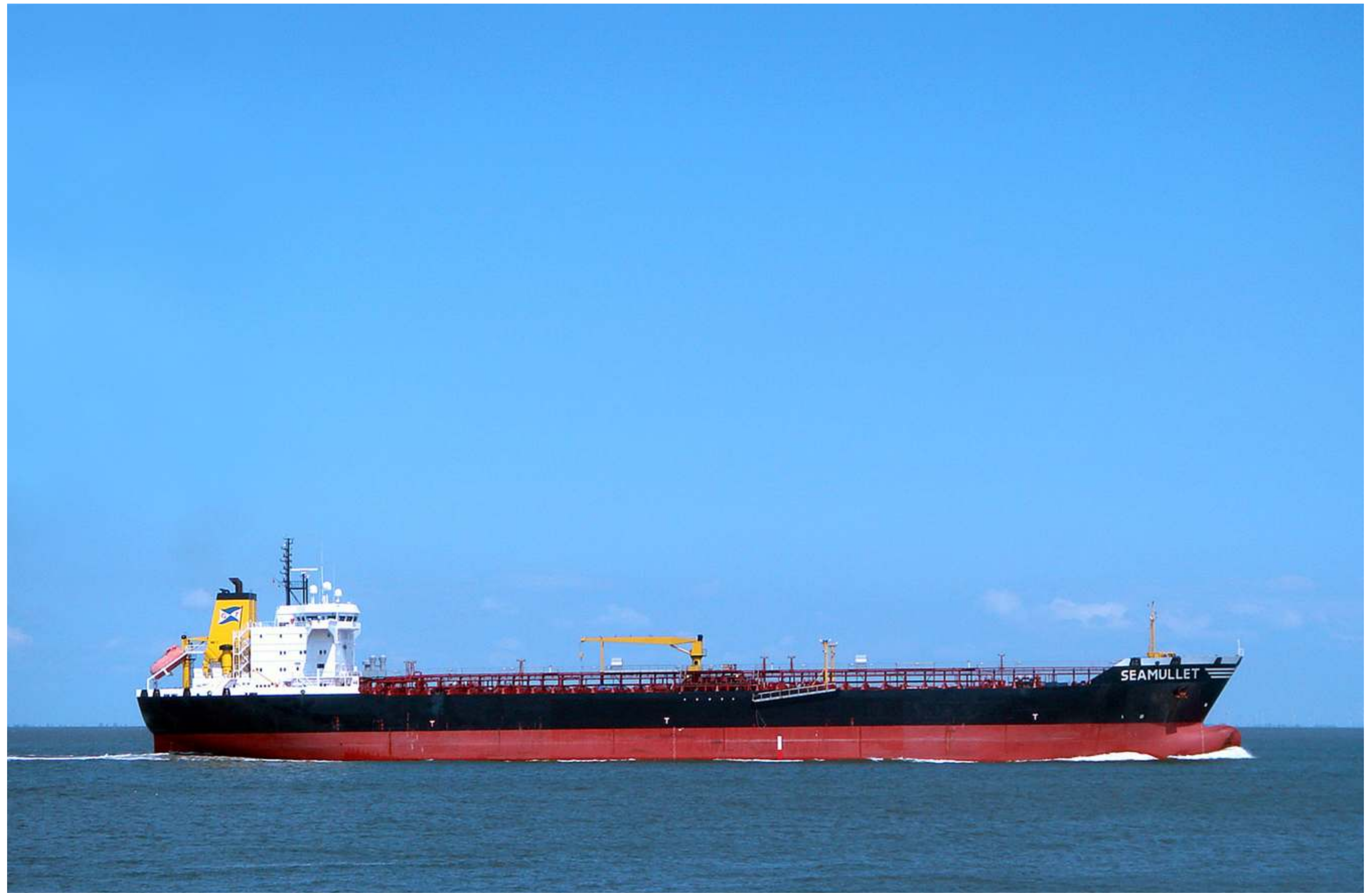
Die ‚Seamullet‘, zu deutsch Großkopfmeeräsche (lat. Mugil cephalus ), ist ein Oil-Products-Tanker und wurde im Jahr 2001 gebaut. Das Schiff, benannt nach einem Meeresfisch, fährt unter deutscher Flagge, ist 170 Meter lang, 28 Meter breit und hat vollbeladen einen Tiefgang von 11 Metern.
